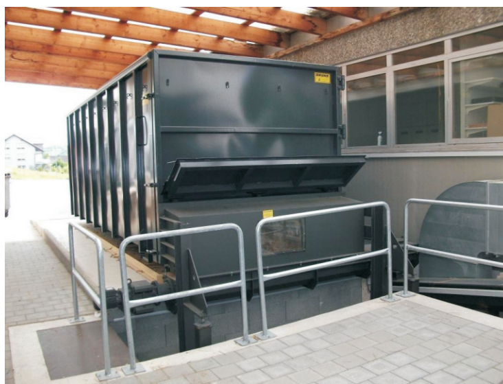
Schubboden-Hackschnitzel-Wechselcontainer: Der Container wird vom örtlichen Hackschnitzellieferanten abgeholt, befüllt und zurück auf das Firmengelände an die Nolting- Andockstation gefahren.
