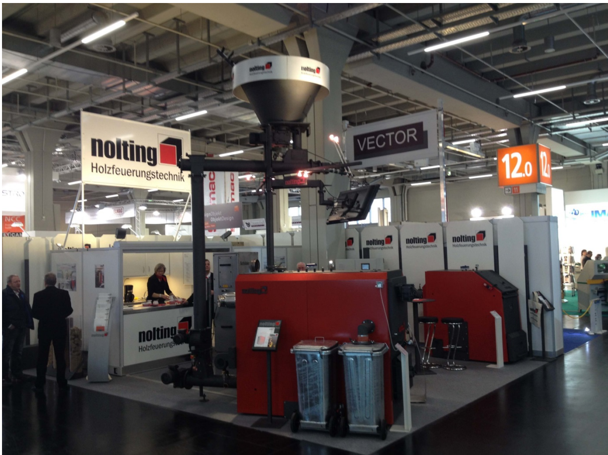
Vorne: autom. Unterschubfeuerung Typ LCS-RU 95/135 mit Siloaustragung und Feinstaubfilter
